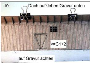
Bei der Baugröße "Null" können auch Magnete in die Ecken und das Dach geklebt werden. Dadurch bleibt das Dach abnehmbar.
